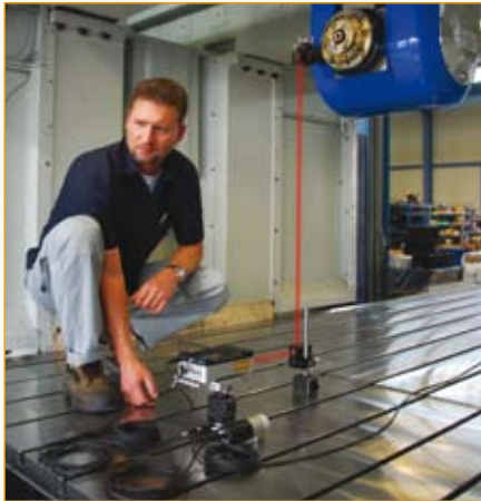
XL-80 Laser Interferometer System im Einsatz
