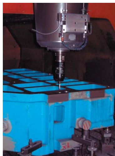
Bild 2. Genauer durch Tasten: Beim Fräsen und Ausspindeln an mehreren Metern langen, breiten und ggf. hohen Werkstücken sorgt das Antasten von Bezugsgeometrien für Lagegenauigkeiten von wenigen hundertstel Millimetern bei den bearbeiteten Taschen und Bohrungen
