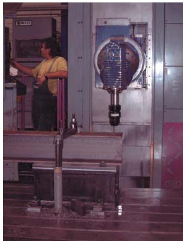
Bild 1. Schneller durch Tasten: Funk-Messtaster minimieren die Rüstzeiten beim Fertigen großer Werkstücke durch Erfassen von Daten zur Nullpunkt-Korrektur
