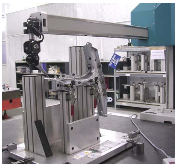
Počítačem řízený automatický souřadnicový měřicí stroj provádí měření vzorku svařovaného celku a při jediném seřizení zkontroluje všechny rozměry
