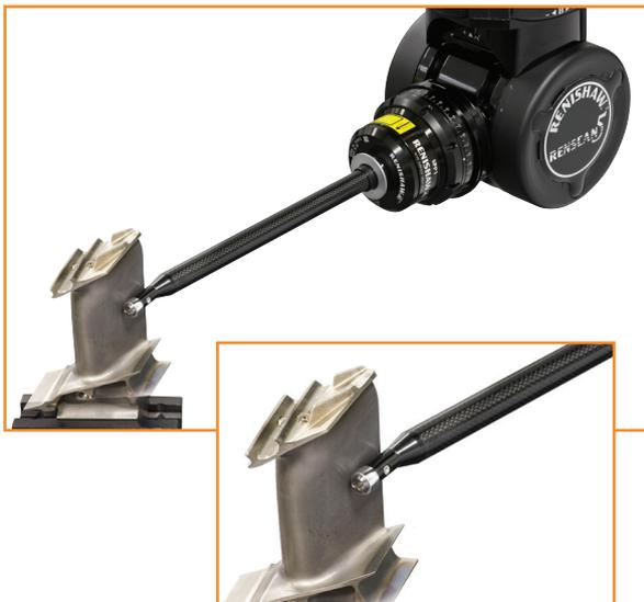
Die C-Achse ermöglicht eine Ausrichtung der Messtasterspitze in einem beliebigen Winkel zum Bauteil.
