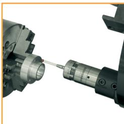
Датчики для контроля деталей - автоматизированное измерение положения и проверка точности выставления детали
