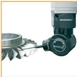
REVO® - система 5-осевого скоростного сканирования и мультисенсорных измерений
