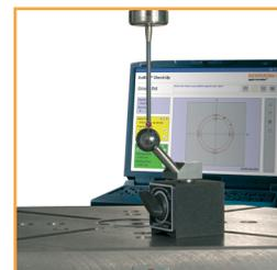
AxiSet™ Check-Up - быстрая автоматизированная проверка состояния поворотных осей на 5-координатных станках
