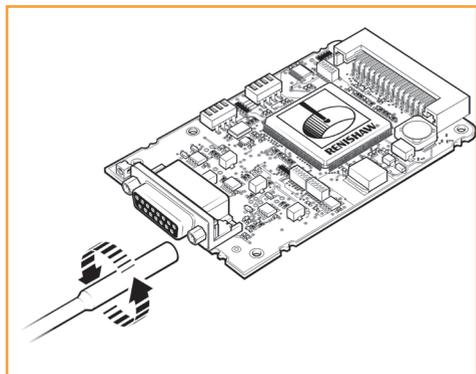
**ステップ 1: RPI20のDサブコネクタから固定用スクリューを外します。**
