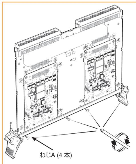
ステップ 4: 4本のねじを取り付けます。ただし、完全に締め付けしないでください。
