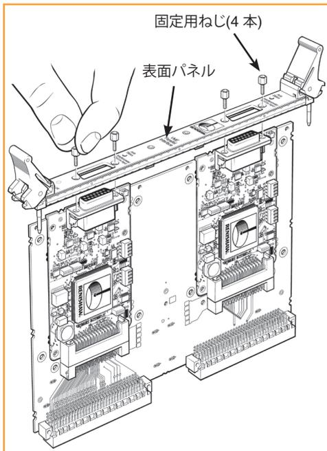
ステップ 3: 表面パネルを通して固定スクリューを再び取り付けます。ただし、完全に締め付けしないでください。
