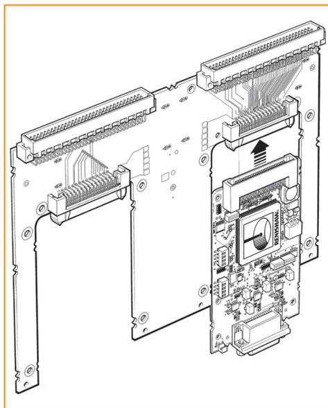
**ステップ 2: 1枚目のRPI20パラレルインターフェースボードをホストボードに設置します。**
