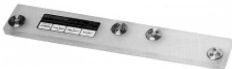
Un master di calibrazione di lunghezza nota per effettuare misure di raggio calibrato. Permette misure a distanza di tempo con un riferimento comune.
