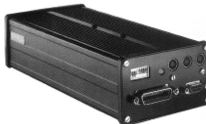
Questa interfaccia mette in relazione il segnale delle righe ottiche con la lettura del laser: quando il conteggio della riga raggiunge i valori determinati dall'utente un segnale diretto al laser causa l'acquisizione di un punto. L'utilizzo di questa interfaccia permette acquisizioni in continuo a velocità di 1m/s senza la necessità di arrestare l'asse in movimento.
