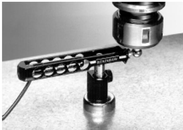
Un kit pensato per macchine di piccole dimensioni, con corse inferiori a 200mm. Permette anche misure su macchine di dimensioni maggiori là dove si voglia misurare il comportamento in caso di forti accelerazioni.
