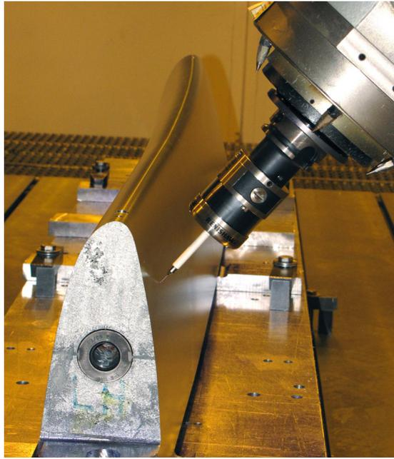
*La tecnologia brevettata RENGAGE consente di effettuare ispezioni in qualsiasi direzione con un'unica calibrazione.*
