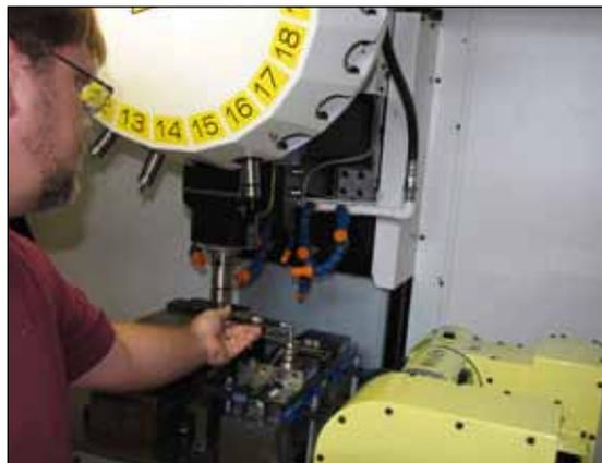
*El ballbar inalámbrico QC20-W solo necesita un reglaje, de menos de 15 minutos, para realizar un ensayo en los planos X-Y, Y-Z y X-Z.*
