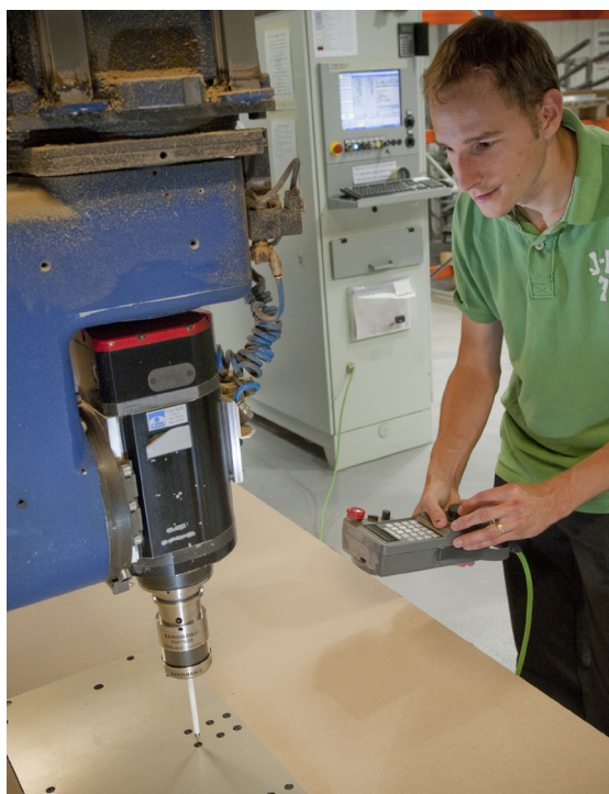
La macchina 5 assi CMS attrezzata con un tastatore RMP600 è utilizzata per lavorare componenti dell'AW159 e altre attrezzature per uso interno
