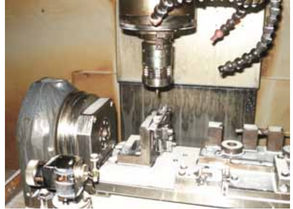
Associated Tooling的机床采用OMP60工件检测测头和OTS光学对刀仪。
