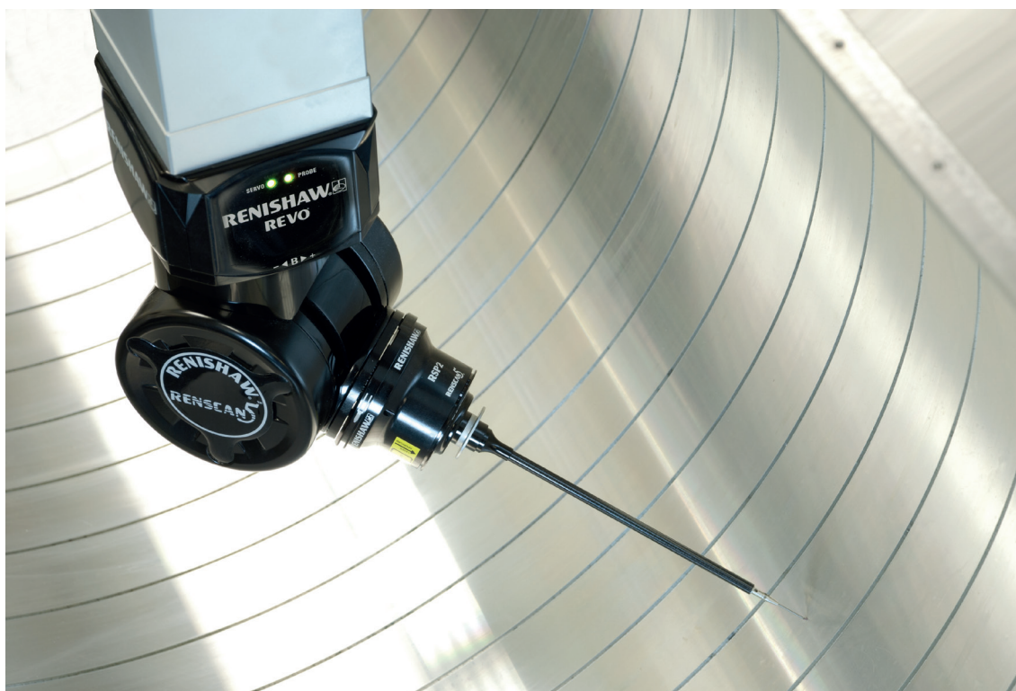
REVO zkrátí trvání kontroly tohoto vysoce přesného zobrazovacího válce z 1 hodiny na 10 minut
