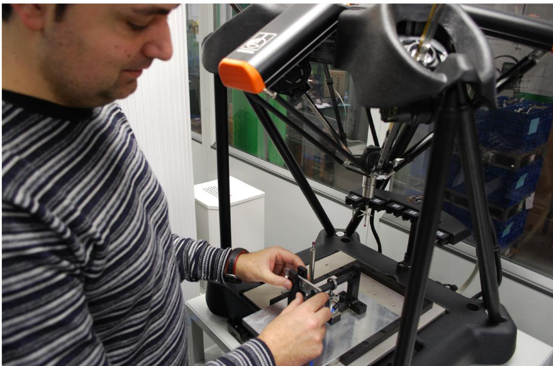
*Un technicien Eponsa charge une pièce de mécanisme d’essuie-glace pour l’inspecter*
