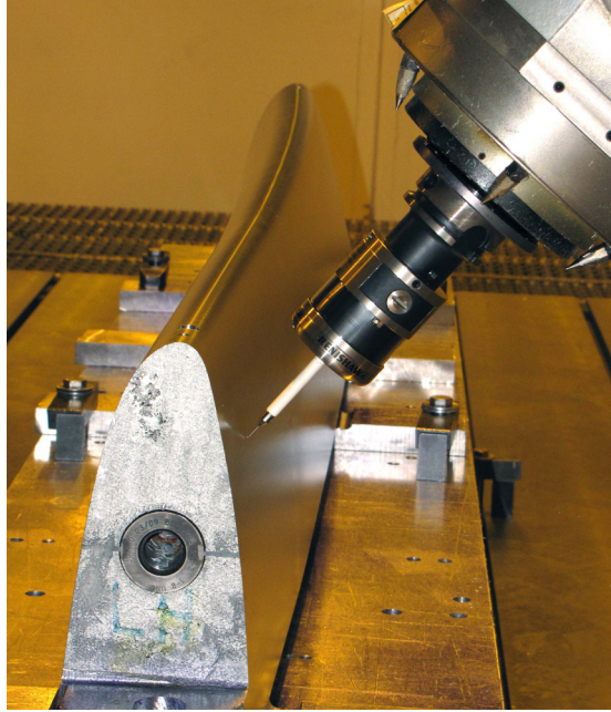
특허 기술인 RENGAGE 를 사용하면 1회의 캘리브레이션으 로 어느 방향에서도 프로빙이 가능합니다. 부품의 프로파일 에 주목하십시오. 프로빙 루틴은 Siemens 840D CNC 에서 실행되는 OMV Pro 소프트웨어에서 오프라인으로 프로그램 되며 PC 에서 오프라인으로 결과가 평가됩니다.
