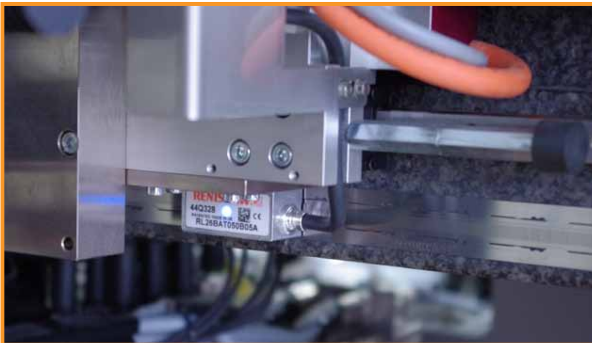
RESOLUTE mentre posiziona gli assi orizzontali e verticali
