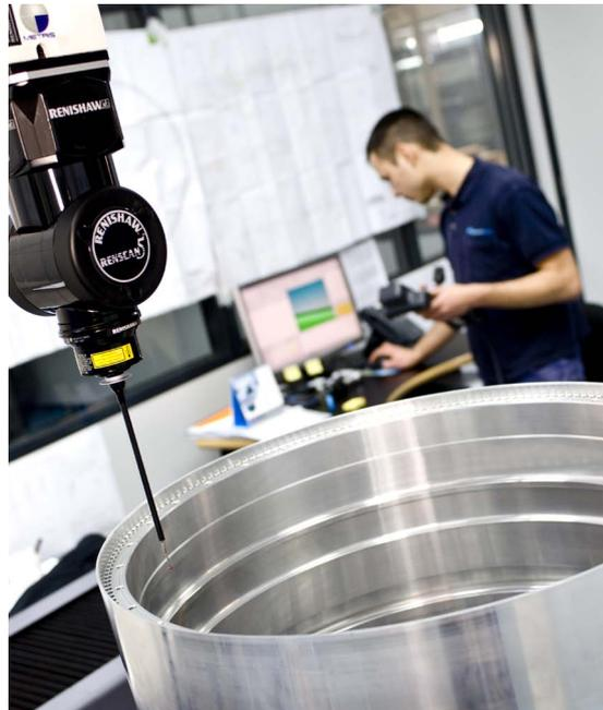
*REVO beim Scannen einer großen Bohrung eines Flugzeugbauteils.*
