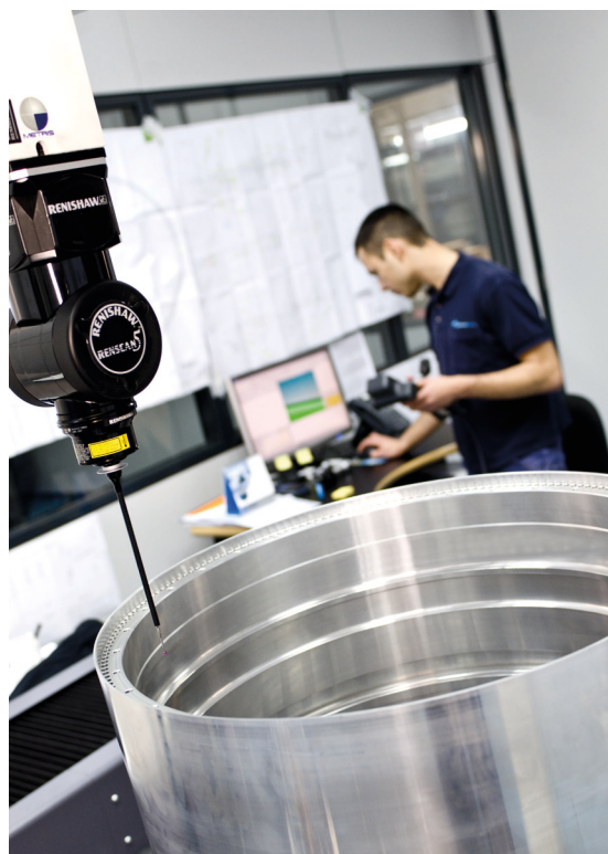
REVO による航空コンポーネントの大型穴の計測
