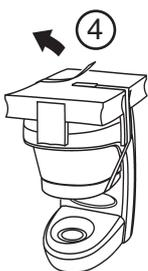
4. Retirez la sangle qui retient la protection du mécanisme.
