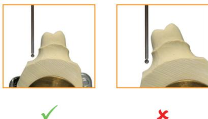
La préparation doit être positionnée de telle sorte que le palpeur puisse accéder verticalement à la totalité de son contour pour le lire. Pour cela, manœuvrez ensemble le support de die et la plateforme de sorte que la limite cervicale soit visible d'en haut.
