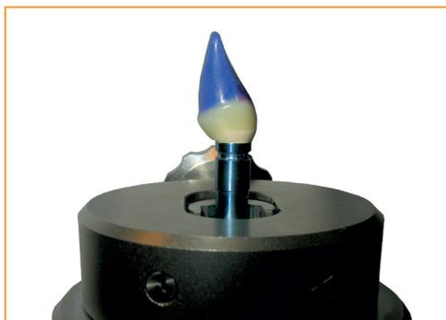
3. Montez l'attache de laboratoire sur le support de pilier. Fixez le support sur la plate-forme de sorte que la vis moletée soit orientée face à l'avant ou à l'arrière du scanner. Positionnez la plate-forme du scanner de sorte que l'attache de laboratoire soit à peu près vertical.
