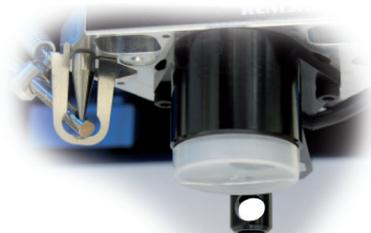
3. Un système magnétique maintient le module en place. Aligned l'avant du module du palpeur (indiqué par le point de repère au-dessus du mot « Renishaw ») sur l'avant du corps du palpeur.
