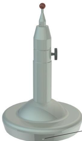
5. Suivez les instructions à l'écran, en montant d'abord l'artefact de calibrage sur le plateau, en veillant à le positionner correctement en alignant les points de repère.
