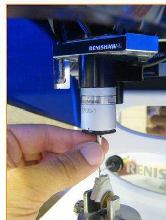
Maintenez la tige du palpeur et placez le stylet au-dessus du centre de la préparation. Veillez à rester dans le volume de travail (tolérances dans les axes XY et Z).
