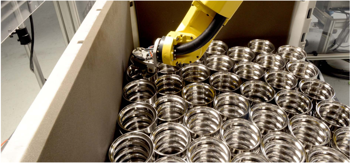
Un robot automático FANUC empaqueta y coloca las piezas en palés
