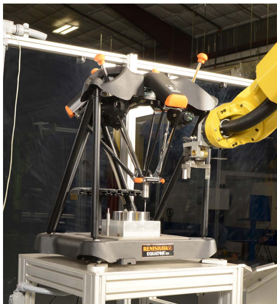
Un robot FANUC carga el Equator en la célula automática
