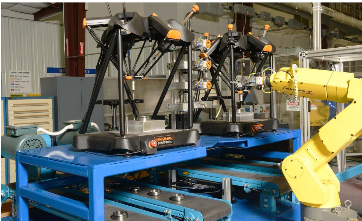
*In fase di sviluppo - la nuova cella automatizzata di Conroe, con due Equator*
