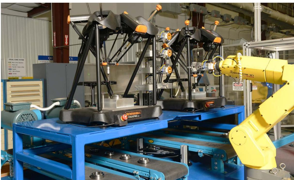
*Em desenvolvimento - nova célula dupla automatizada Equator da Conroe*
