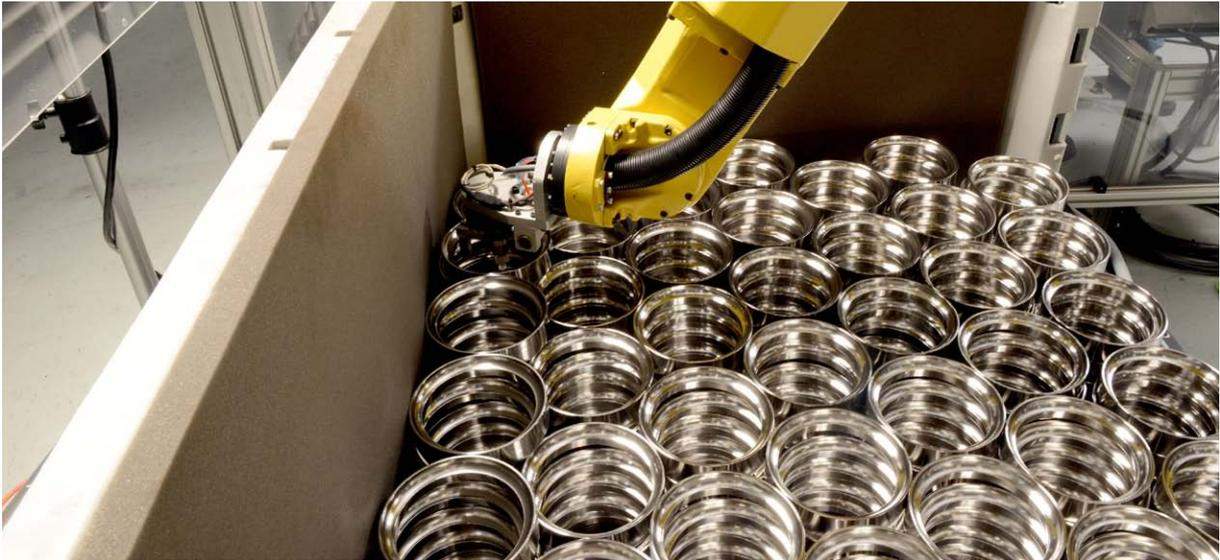
*Um robô FANUC automatizado encaixota e paletiza as peças acabadas*
