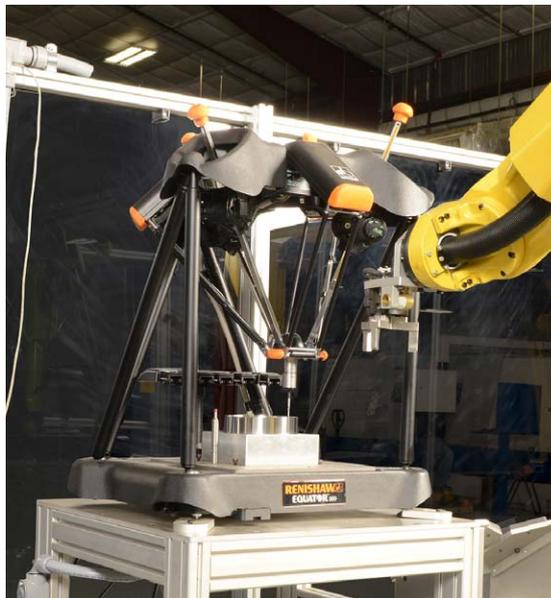
*Um robô FNUC carrega o Equator na célula automatizada*
