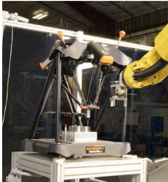
自动化单元中的FANUC机器人将工件装载到Equator比对仪中
