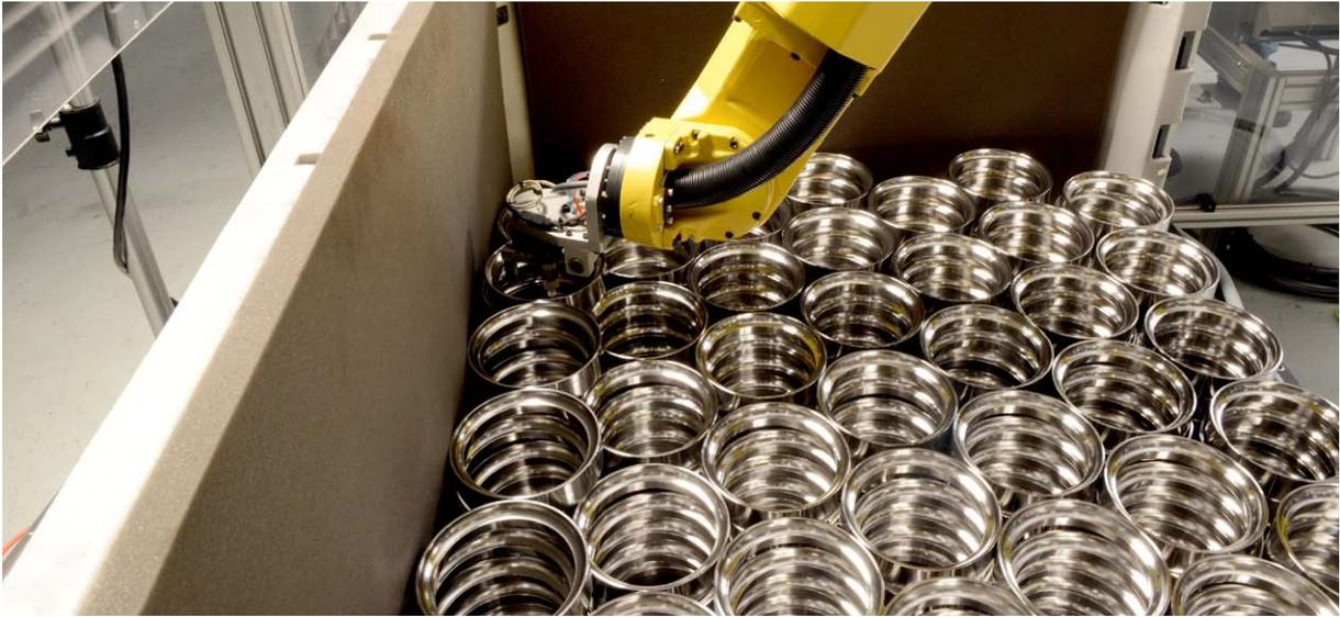
*Un robot FANUC conditionne les pièces et les palettise*
