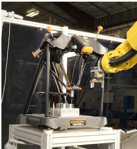
*Un robot FANUC charge l'Equator dans la cellule automatisée*
