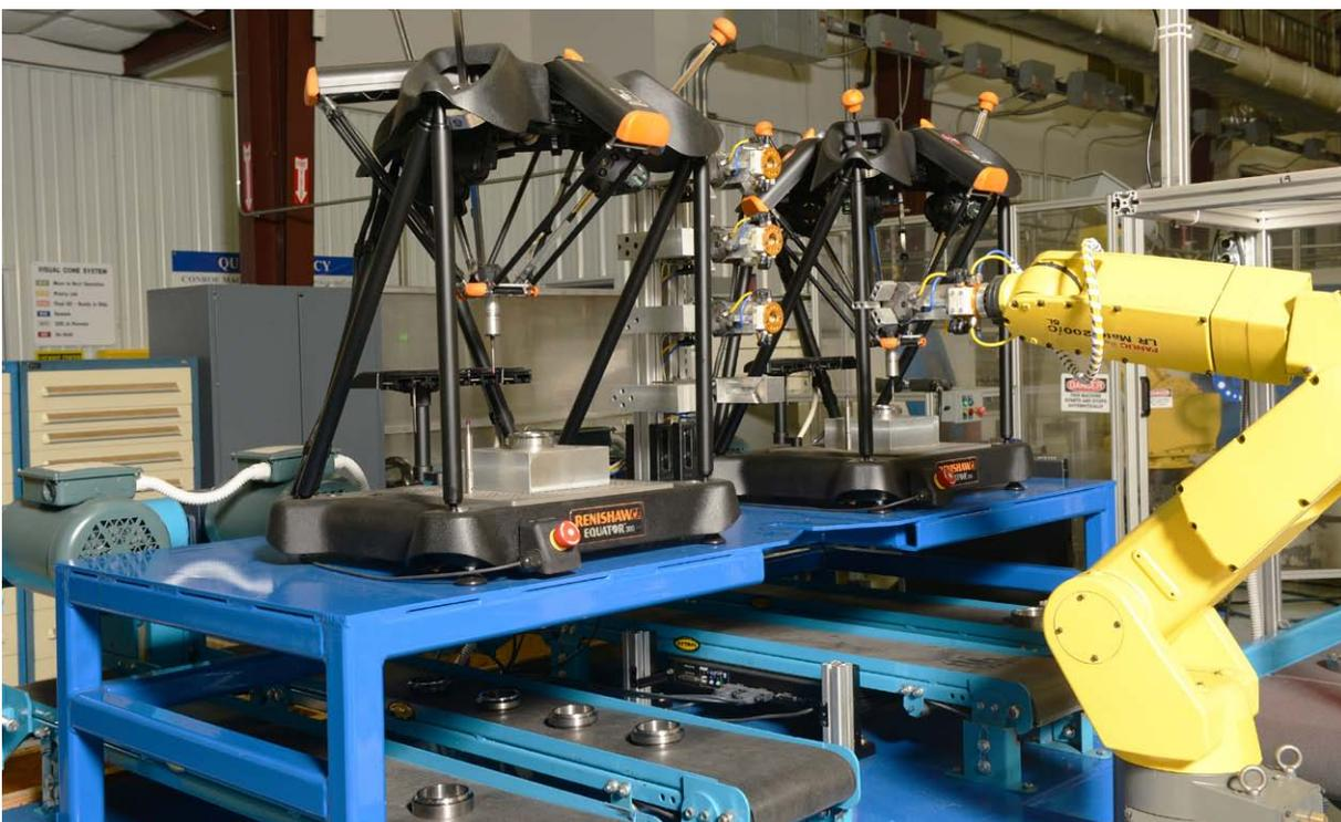
En cours de développement – La nouvelle cellule automatisée Equator de Conroe
