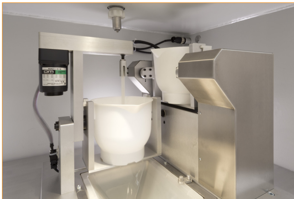
Innenansicht der oberen Kammer einer Renishaw Vakuumgießmaschine 5/04 V
