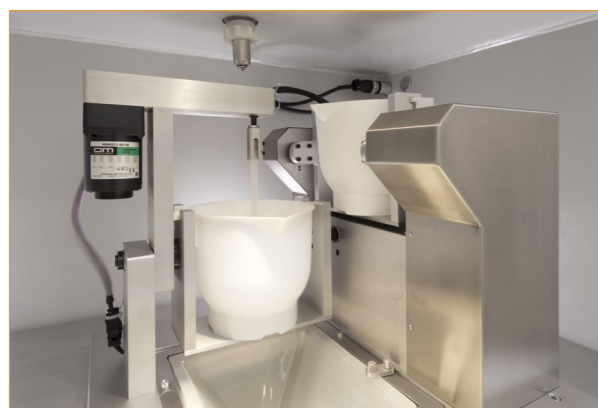
Interior da câmara superior da máquina de fundição a vácuo 5/04 V Renishaw
