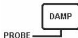
Die Messtasterdämpfung ist eine Funktion des Renishaw Messtasters-Interface. Sie reduziert die Empfindlichkeit des Messtastersystems sowie die Anzahl unerwünschter Fehlantastungen, die aufgrund von KMG-Bewegungen oder Vibrationen während der Positionierbewegungen auftreten können.
