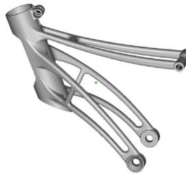
3. Riprogettato da Empire Cycles utilizzando il modello CAD ottimizzato come modello
