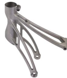
4. Realizzato in lega di titanio su un sistema di fusione laser Renishaw AM250
