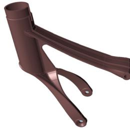
1. Il modello CAD del supporto per la sella progettato per accogliere una fusione di lega in alluminio
