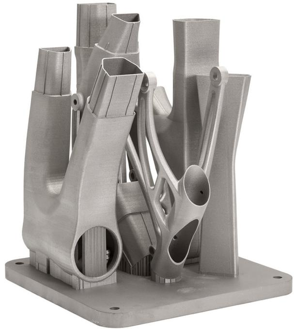
整台腳踏車骨架依部位排放後，將座桿架放置在平板上並連續完成組裝
