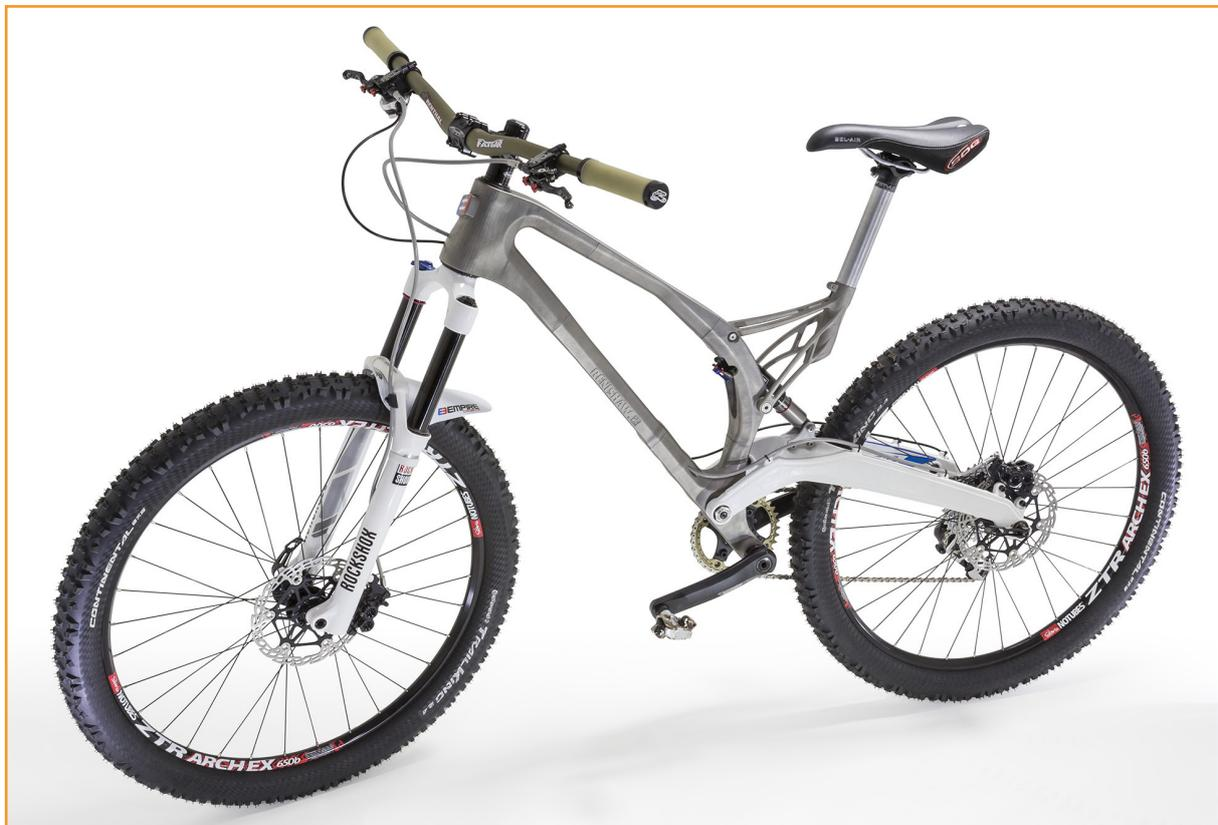
以 3D 列印鈦合金骨架和座桿架完成自行車產品
