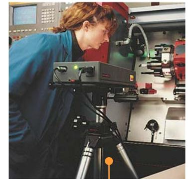
Первая лазерная интерферометрическая система Renishaw
