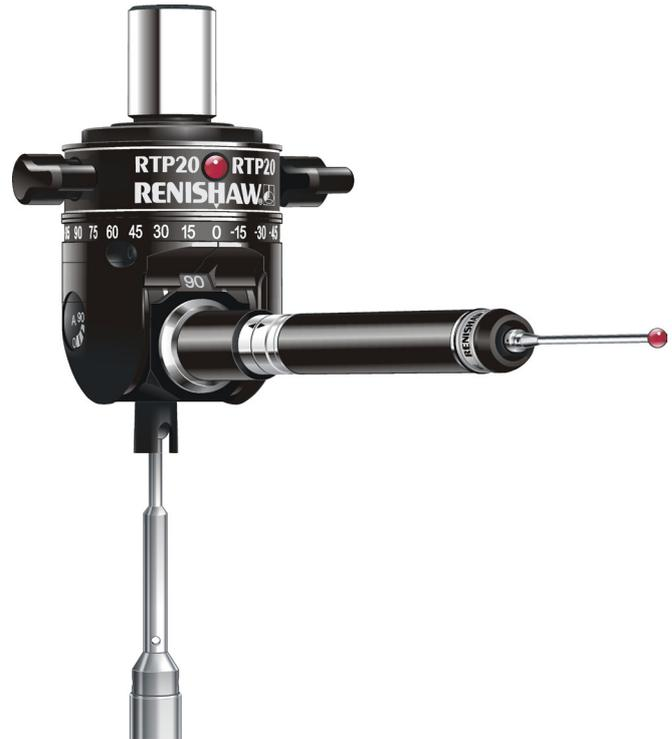
Die im Tastkopf integrierte TP20 Tasteraufnahme nutzt den maximalen Arbeitsbereich des Koordinatenmessgerätes und bietet Kompatibilität mit allen Tastermodulen des TP20 Messtastersystems. Obwohl die Tastermodule manuell gewechselt werden können, kann der RTP20 zusammen mit dem MCR20 Wechseltrommel eingesetzt werden, wodurch ein automatischer Tastermodulwechsel möglich wird.
