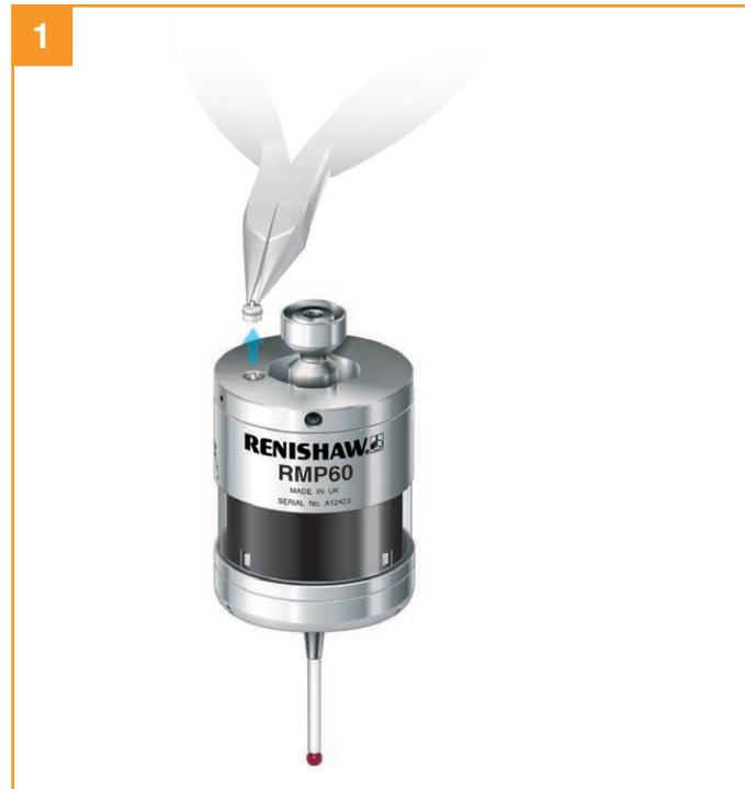
**注意:** RMP60 をシャンクスイッチで使用する際は、プローブ後方にあるプラグをプライヤー等で取り外す必要があります。そして代わりにボビン (A-4038-0303) を取り付けます。
