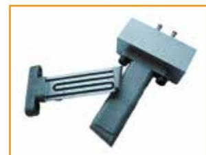
Outillage avec canaux de refroidissement conforme
