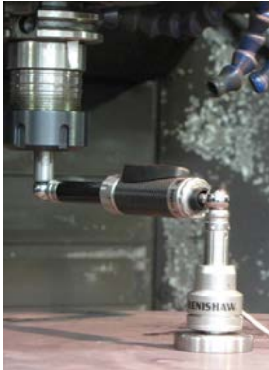
VMC 테스트를 수행하는 QC20-W 무선 볼바
