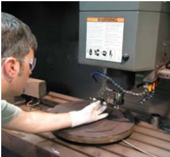
Silfex에서 무선 볼바를 선반에 셋팅하는 모습
