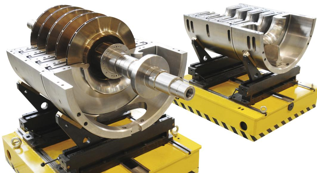
*Compresores GE Oil and Gas durante el ensamblaje, mostrando las turbinas en su lugar*
