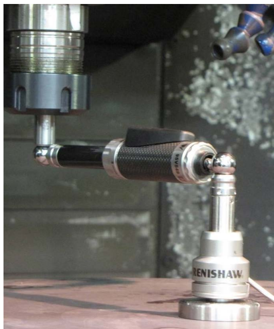
Sistema ballbar QC20-W wireless mentre esegue un test su un centro di lavoro verticale
