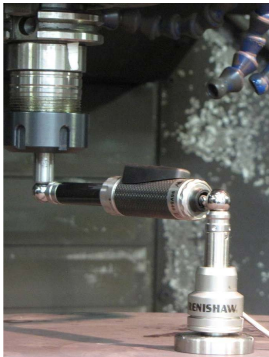
Brezžični QC20-W ballbar med izvedbo preskusa na vertikalnem obdelovalnem centru
