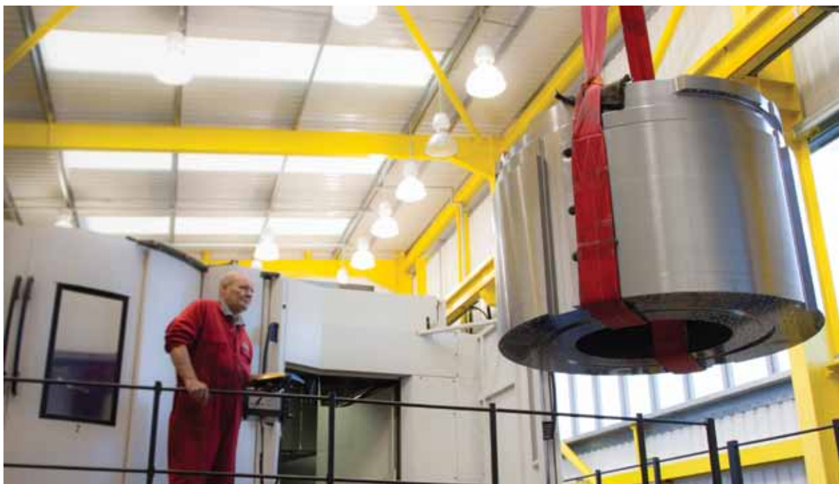
Intoco公司使用Mazak INTEGREX e-1850V来加工大直径组件
