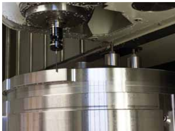
在制造过程中，Intoco公司使用雷尼绍测头测量系统来测量大型组件
