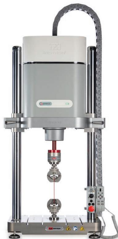
Instron の E3000 リニアトーション試験装置で試験中のポリエチレンサンプル
