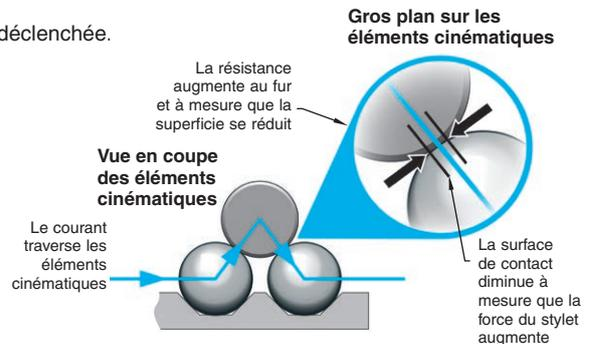
Un déclenchement électrique répétable et un retour au repos mécanique du mécanisme sont indispensables à ce processus et à la fiabilité de la mesure.
