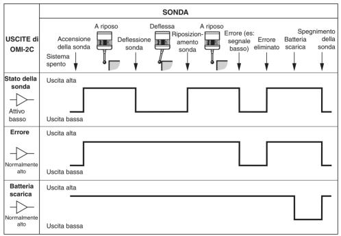
I segnali in uscita emessi dall'unità OMI-2C devono essere compatibili con gli ingressi del controllo della macchina.
