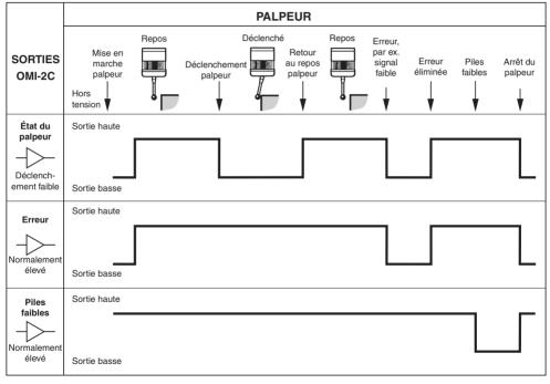
Les signaux de sortie de l'OMI-2C doivent être compatibles avec l'entrée de l'automate machine.
