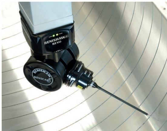
Система REVO позволила сократить время проверки работы высокоточного барабана с 1 часа до 10 минут
