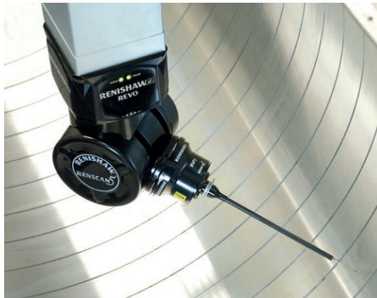
REVO har minskat kontrolltiden för denna högprecisions-bildtrumma från 1 timme till bara 10 minuter
