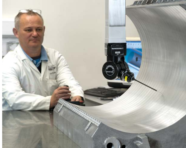
Phill Smith från Future AM:s mätavdelning ställer upp mätningen av en bildtrumma för kunden Highwater Products med ett femaxligt REVO-mätsystem
