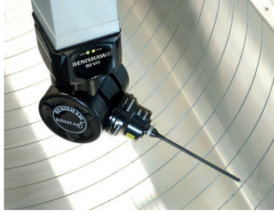
REVO bu yüksek hassasiyetli görüntüleme tamburunun denetleme süresini 1 saatten yalnızca 10 dakikaya indirmiştir
