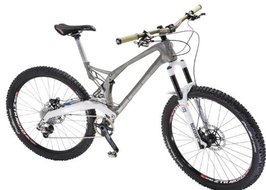
*Ce VTT a été développé par Renishaw et Empire Cycles en utilisant la fabrication additive*
