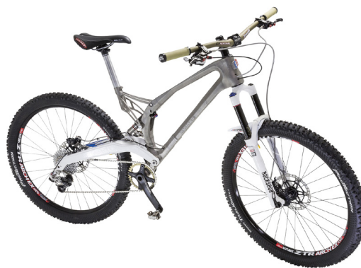
Questa mountain bike è stata sviluppata da Renishaw ed Empire Cycles e realizzata in maniera additiva.
