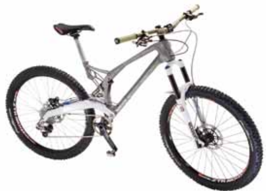
该山地自行车由雷尼绍和Empire Cycles公司采用增材制造技术开发
