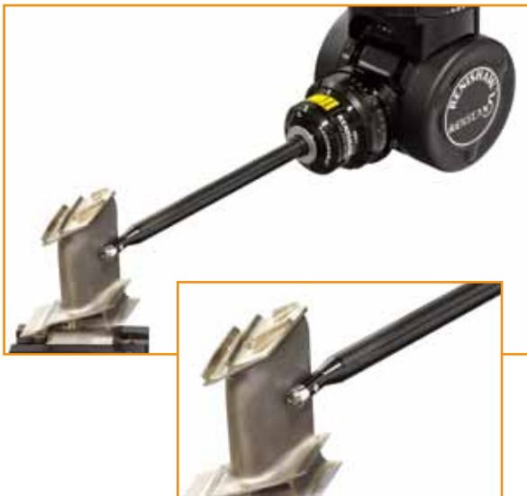
C轴允许调整测头测尖至任意角度来适应工件。
