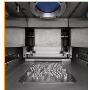
Der Bauraum der Laserschmelzsysteme AM
