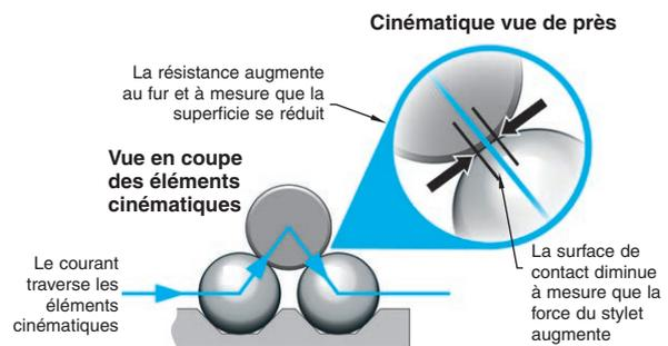
Un déclenchement électrique répétable et un retour au repos mécanique du mécanisme sont indispensables à ce processus et à la fiabilité de la mesure.
