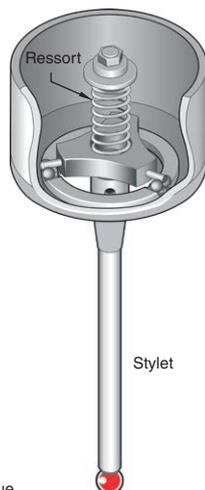
La force du ressort crée des zones de contact, entre les billes et les rouleaux, au travers desquelles passe le courant électrique. Lorsqu'il y a un contact (physique) avec une pièce, la force appliquée par le stylet éloigne les billes des rouleaux, réduit la taille des zones de contact et augmente leur résistance électrique.
